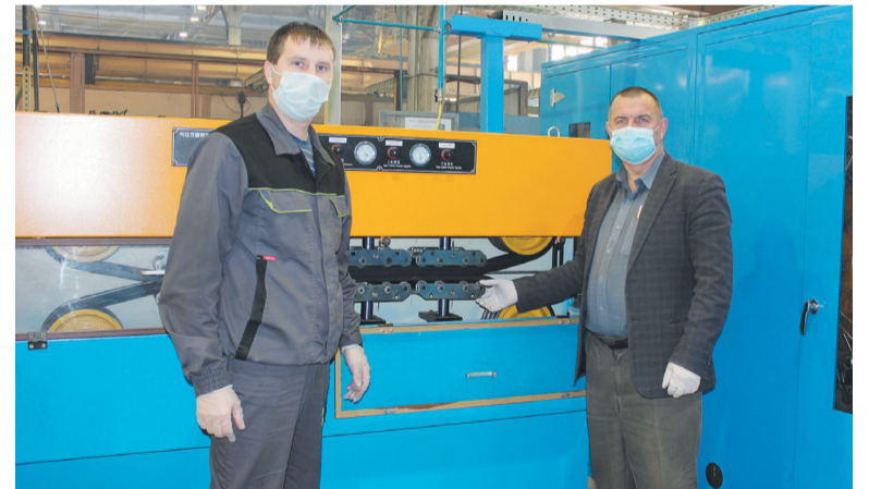
Механик цеха 17 А.В. Булатов и начальник бюро СГМ А.Г. Новиков проводят осмотр тягового устройства оплеточной машины WGSB-2.
