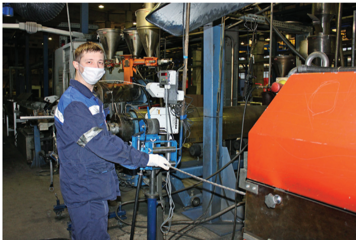
Скрутик изделий кабельного производства Н.В. Кирьянов выполняет заправку провода СИП на линии RNA-1
