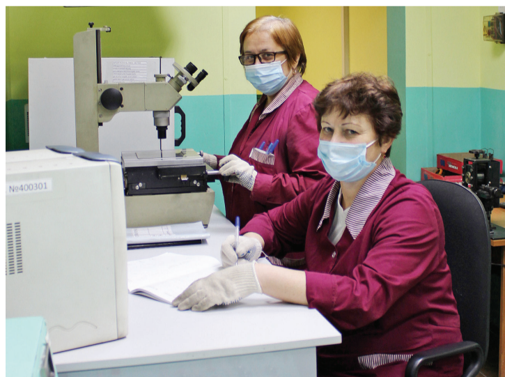
Контролеры кабельных изделий Т.И. Шептунова, Т.И. Кощеева измеряют толщину изоляции на электронном микроскопе
